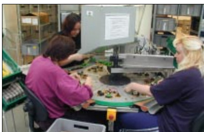
Pracovnice při výrobě kabelových svazků Foto z projektu KES
